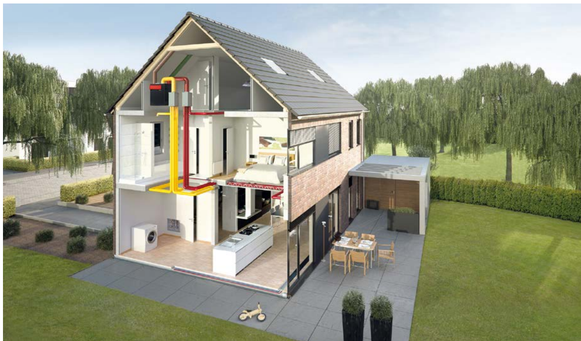
► Schemat wentylacji mechanicznej z rekuperacją
