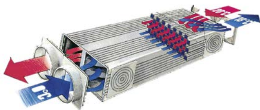
► Schemat działania wymiennika kanalikowego
