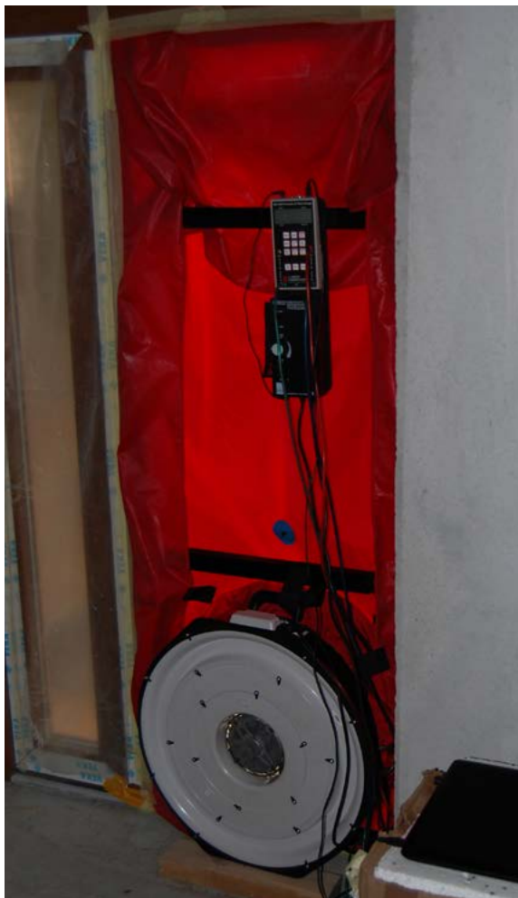
► Urządzenie do badania szczelności budynków Blower Door
