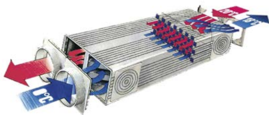
► Schemat działania wymiennika kanalikowego
