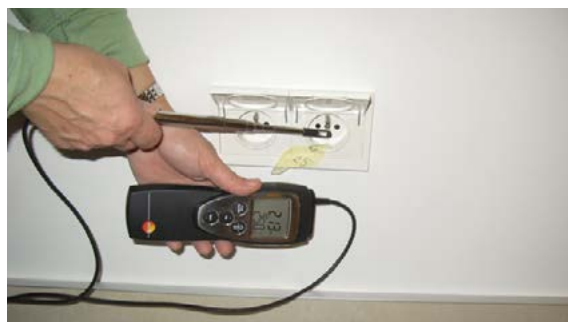
► Badanie przy pomocy anemometru
